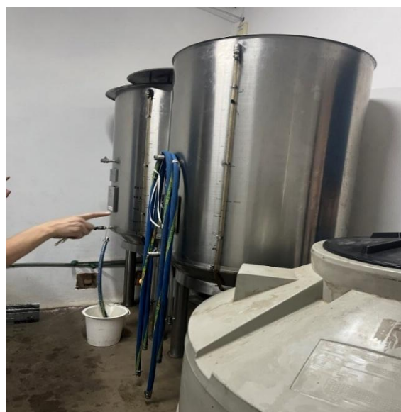
Foto 13. Recirculadora y panel de refrigeración para bajar la temperatura del aceite de oliva instalados en el establecimiento de Vanina Griffouliere
