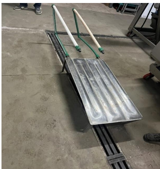
Foto 13. Recirculadora y panel de refrigeración para bajar la temperatura del aceite de oliva instalados en el establecimiento de Vanina Griffouliere
