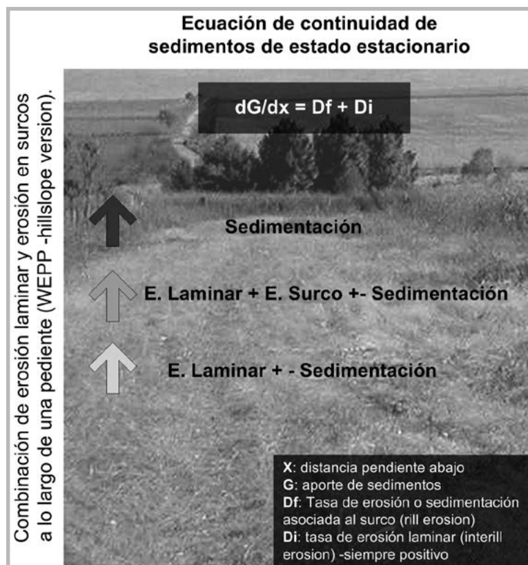
Figura 17. Ecuación de continuidad de erosión/sedimentación del modelo WEPP. En cada punto de la ladera se puede determinar la combinación de acciones de desprendimiento y transporte de sedimentos originados por las erosiones entre surcos (laminar) y en surcos.
