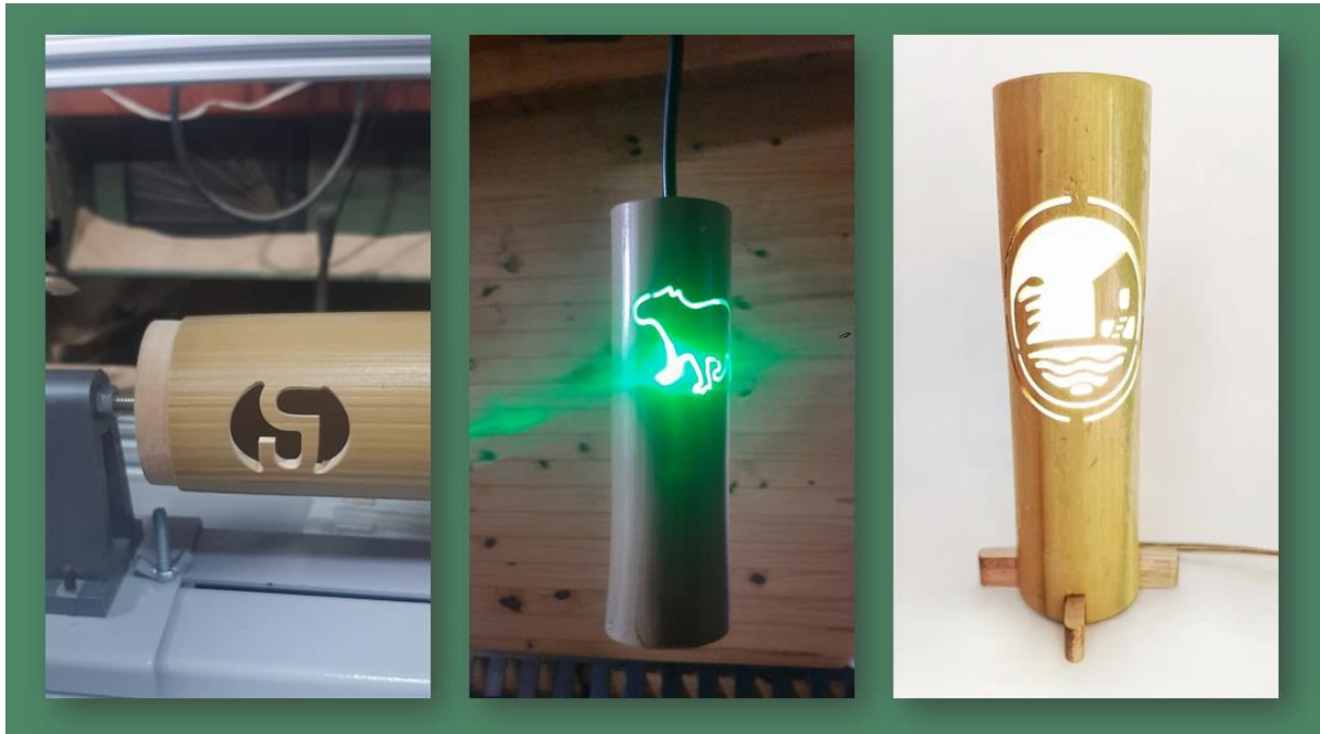
Figura 1. Lámparas de bambú talladas con logos personalizables, talladas con el CNC adquirido con el subsidio de 2024
